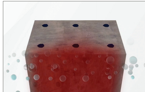
02 콘크리트의 수산화칼슘이 사라지고 탄산칼슘으로 바뀌면서 콘크리트의 중성화가 진행
